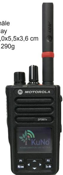
Durch klare Sprachansagen erhält der Nutzer direkt wichtige Informationen zu Kanal oder Akkustand ohne dass der Forstarbeiter das Funkgerät vom Gürtel nehmen muss.
